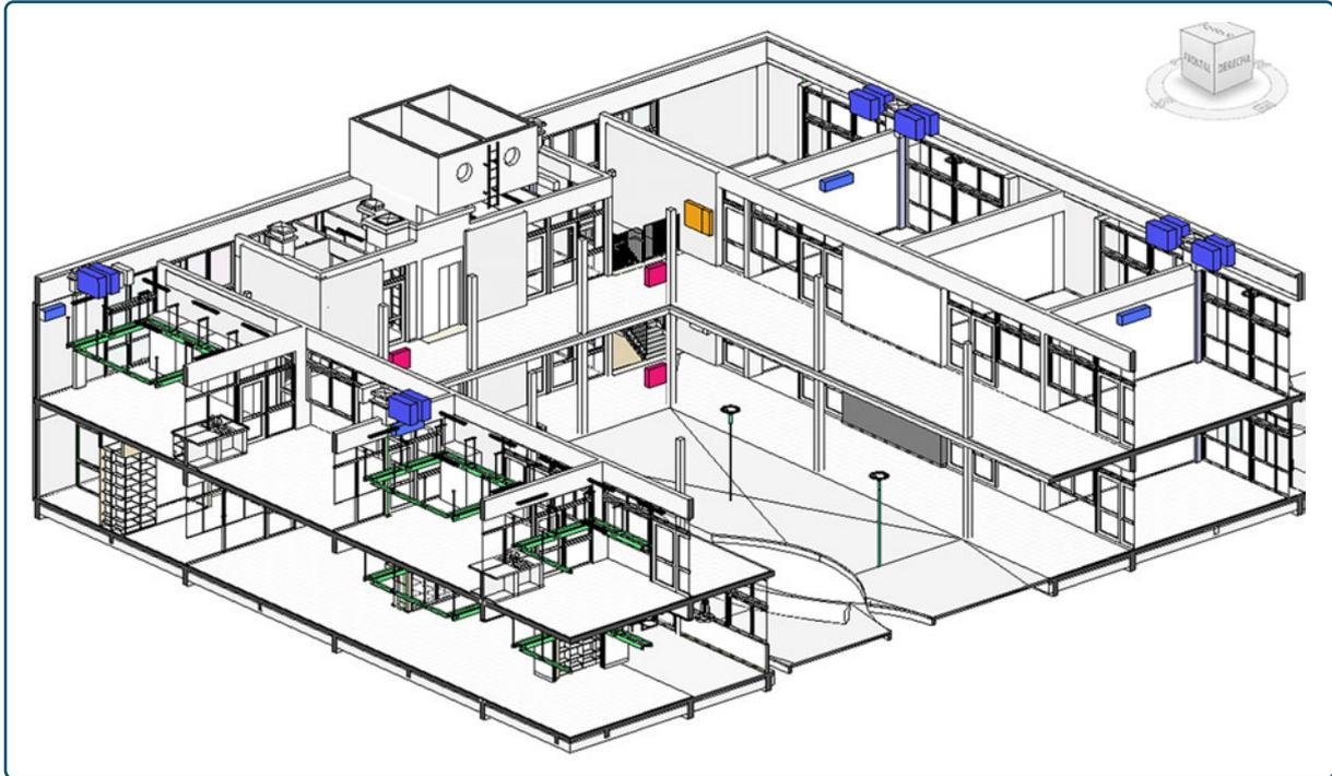
Modelado de componentes vistos de las instalaciones que generan interferencias y tienen incidencia en el diseño
